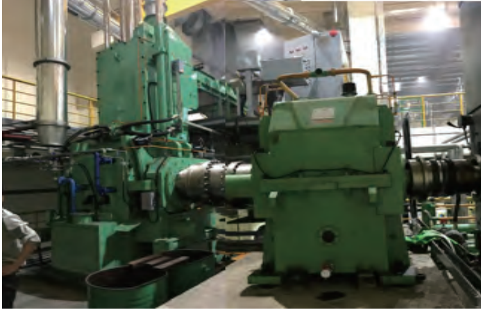
百万美金印钞机— Sahara沙漠南边金矿球磨机变频驱动应用案例
