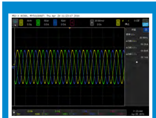
图1. 48脉波整流时的输入电流
